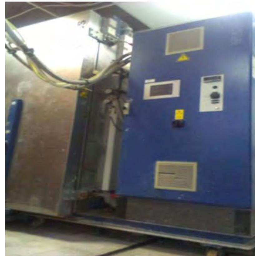
Проведение эксперимента в климатической камере на влагонакопление в СФТК
