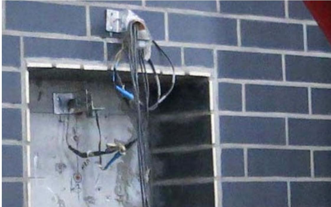
Акселерометры, установленные на ж/б-основании и внешнем слое СФТК
