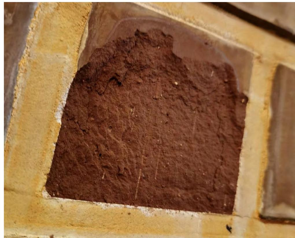
Плитка керамическая, водопоглощение более 8,0%, отрыв по телу плитки.
