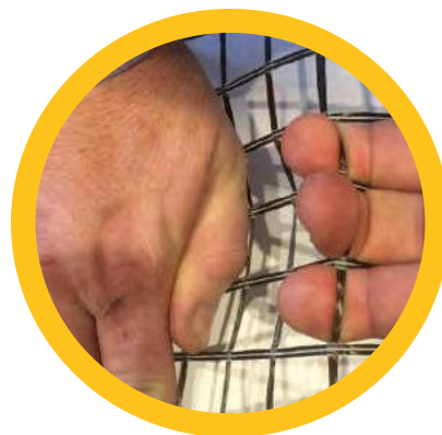
Прошитое и проклеенное сочленение ячеек
