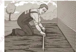
Направляющие и правило используют для финишного выравнивания поверхности и более точного устройства уклона. В качестве направляющих используются доски, трубы, и др. материал, который укладывают таким образом, чтобы уклон от стены дома до бордюра составил 1,5-2%. После окончания выравнивания направляющие удаляются, а выемки заполняются посыпкой.
