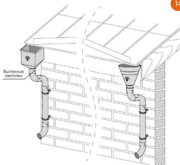
Воронка водосборная имеет соединительный шов, который не предусматривает полной герметизации изделия. Во время интенсивных ливневых дождей допускаются протечки через соединительный шов.
