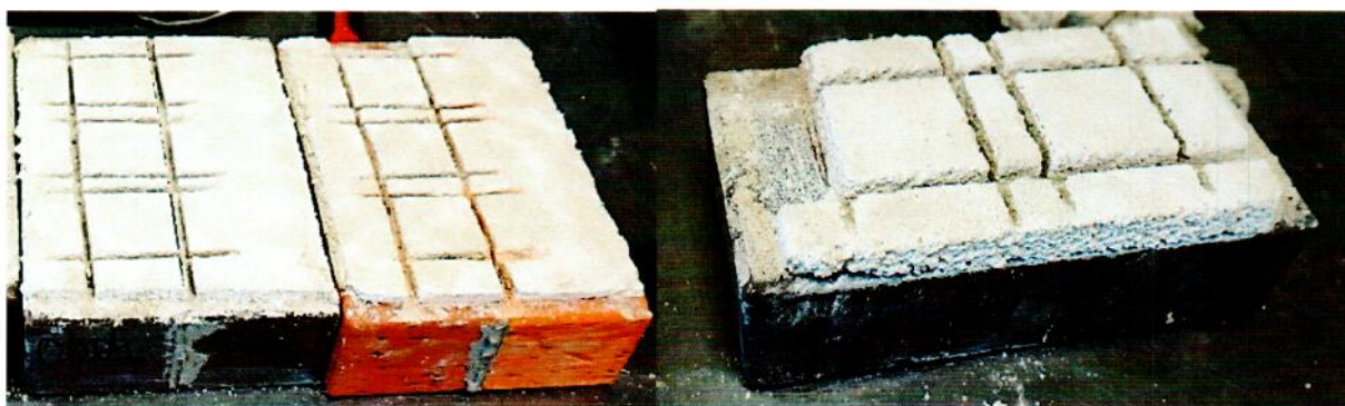
Рис.1-2 Образцы перед испытанием на адгезию.
