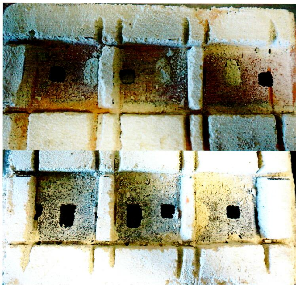
Рис.4-5 Характер отрыва после испытанию на адгезию к кирпичам.
