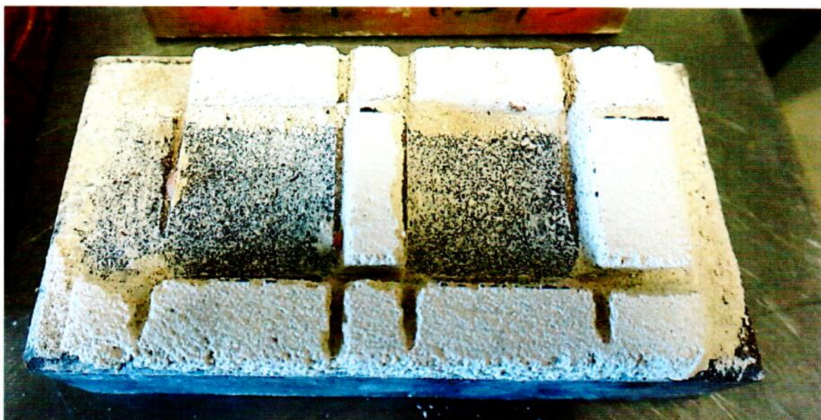
Рис. 6 Характер отрыва после испытания на адгезию с брусчаткой.
